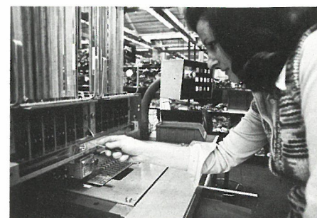
La stessa operazione viene effettuata anche per i componenti a reofori verticali.
